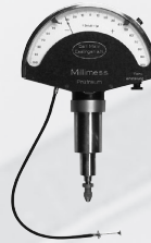
Millimess Feinzeiger, Baujahr 1937. Erstes Anzeigegerät zur sicheren Erfassung von Maßunterschieden 1/1000 mm
