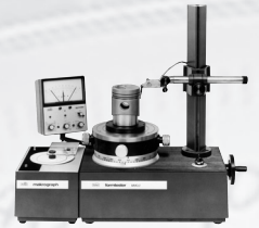
MMQ 2, kompakter Tisch-Formtester zur Auswertung von Rundheit
