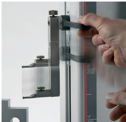
Bild 1. Messschlitten mit Hand in Richtung Messobjekt bewegen.
