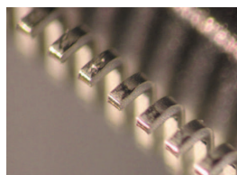
Przykład pomiaru : Wysokość wyprowadzeń obudowy QFP
