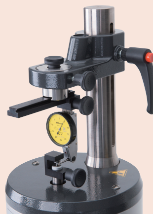
Wzorcowanie czujnika dźwigniowo-zębatego z dodatkowym wyposażeniem
