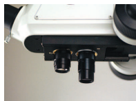
Zastosowanie opcjonalnego przesuwnego modułu zmiany obiektywów, 2 obiektywy (opcja fabryczna)
