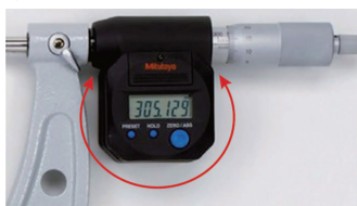
Wyświetlacz obracany w zakresie 330°
