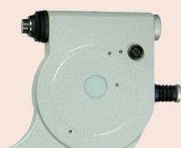
Śruba do regulacji mikrometru \pm 5 \mu m
